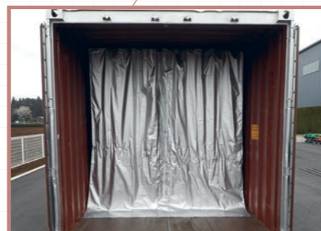
耐熱カーテン 熱気を外に逃がさないために利用します。 また、敷居として突入前の準備スペースを確保します。
