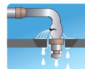
配管内の水は周囲の温度変化によって膨張収縮を繰り返すためフレキシ部分等を破損させ水損を発生させる。
