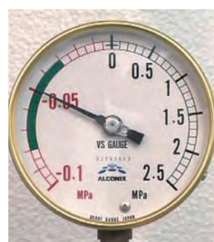
夏場の特に最上階の天井裏にある配管内の水温は異常に上昇します。それにより水は膨張し異常昇圧を発生させ、配管・機器を破壊する恐れがあります。さらに地球温暖化が進むと、異常昇圧による破損事故がよりいっそう心配されます。真空スプリンクラーは2次側の圧力を常に-0.03Mpa以下で監視しているので異常昇圧は発生しません。
