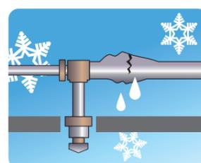
寒冷地に多い被害。水の凍結・膨張により、配管やヘッド部分が破損し解氷後、水漏れが発生する。
