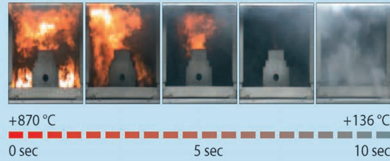
2.5m 3 の模擬エンジンルームにおける消火実験
