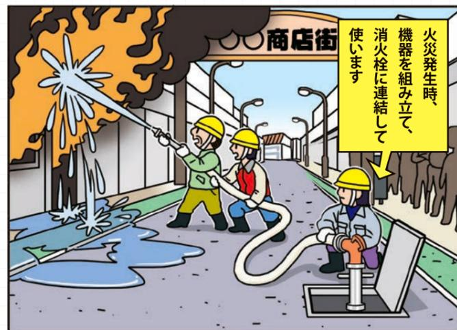
火災発生時、機器を組み立て、消火栓に連結して使います
