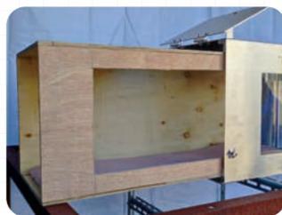
火災性状の効果を向上させる目的でステンレス製ボックス内に、木製ボックスを組み込む仕様です。
