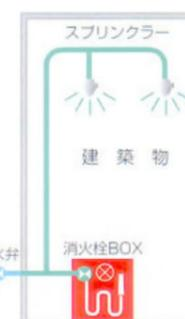
圧力水槽内の消火用水は、加圧ガス容器から圧送される窒素ガスを圧力調整器により一定の圧力に減圧し、常時加圧された状態で貯蔵しています。スプリンクラーヘッド・消火栓バルブ等が開放されると送水します。
